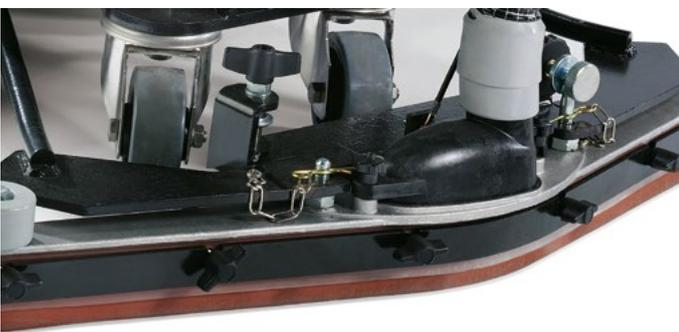
Il tergipavimento si regola facilmente per inclinazione e pressione delle gomme ed è dotato di due ruote che servono a dare stabilità di funzionamento. Le gomme sono utilizzabili sui due lati.
